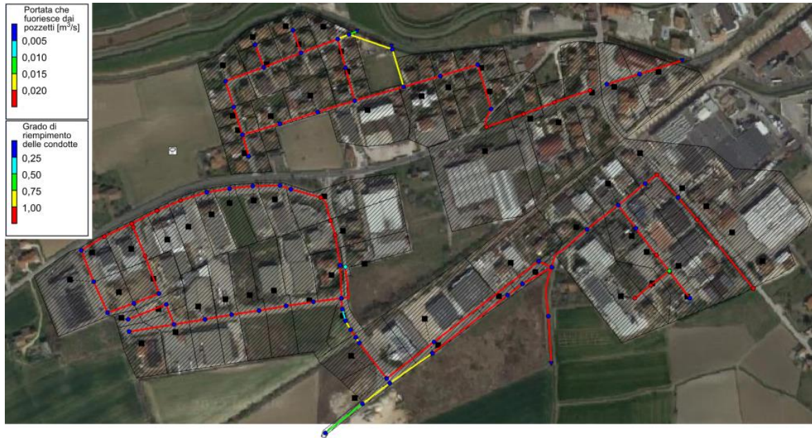
Figura 2-19: Rete fognaria della zona di Sossano a sud dello scolo Liona, stato di fatto dopo 18 minuti dall'inizio della precipitazione (momento più gravoso); il colore delle tratte di rete dipende dal loro grado di riempimento; il colore dei nodi dipende dalla portata fuoriuscita dagli stessi.
