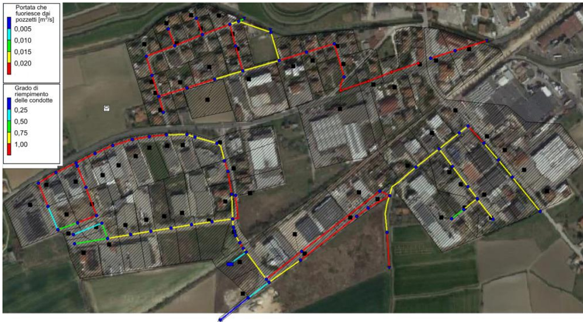
Figura 2-23: Rete fognaria della zona di Sossano a sud dello scola Liona, stato di progetto (alternativa progettuale 2 con invaso a valle del sifone) dopo 19 minuti dall'inizio della precipitazione (momento più gravoso); il colore delle tratte di rete dipende dal loro grado di riempimento; il colore dei nodi dipende dalla portata fuoriuscita dagli stessi.
